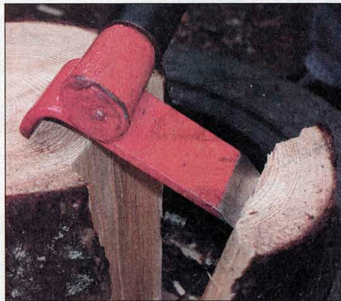
Muodon vuoksi. Vipukirveen teho perustuu toispuoleiseen painojakaumaan ja automaattisesti syntyvään vipuliikkeeseen.
